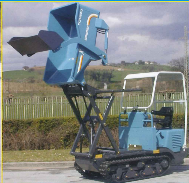
High tip skip with (without) selfloading shovel Pritsche mit Entladung in variabler Höhe mit / ohne Selbstladeschaufel Бункер с высокой разгрузкой, возможна комплектация самогрузчиком.
