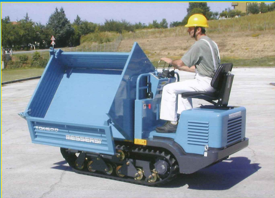
3-way skip / Erhobene Pritsche / Бункер с возможностью трехсторонней разгрузки
