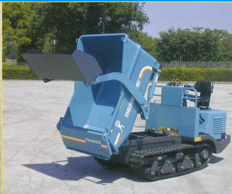
Frontal dumping skip with (without) selfloading shovel / Pritsche mit frontaler Kippung mit / ohne Selbstladeschaufel / Бункер с фронтальной разгрузкой, возможна комплектация самогрузчиком.
