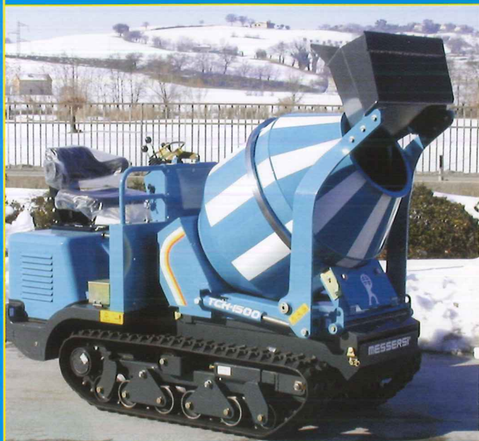
TCH-1500/BET with concrete mixer of 0,36 m 3 output capacity / TCH-1500/BET mit Betonmischeinheit mit 0,36 m 3 Fassungsvermögen / TCH-1500/BET Миксер с регулируемой скоростью вращения и самогрузчиком.
