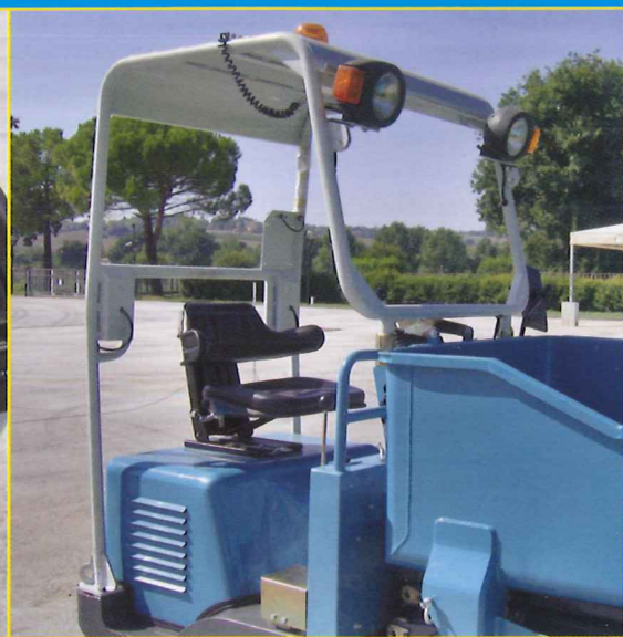
ROPS-FOPS canopy (for on road use also) / Schutzdach ROPS-FOPS mit Strassenzulassung / Навес ROPS-FOPS (также для применения на дорогах)
