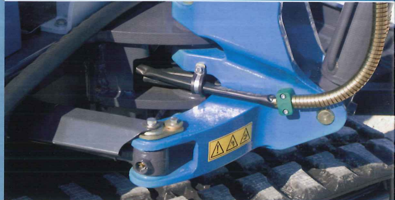
Details of the excavating arm articulations / Detail Armgelenk / Изображение шарнирного соединения плеча
