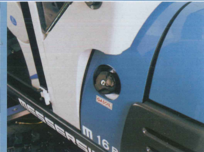
Refuelling access is external to the engine compartment / Der Tank des Kraftstoffes ist von der Aussenseite der Maschine zugänglich / Подача дизельного топлива является доступной с наружной части машины
