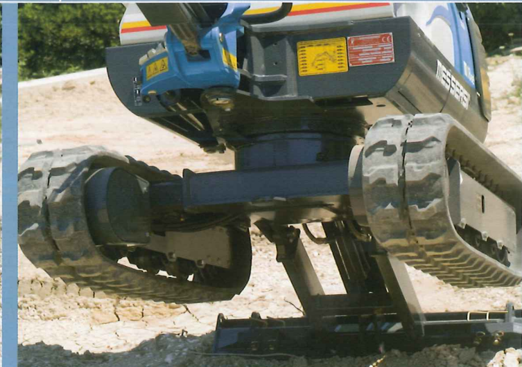
Hydraulic track widening from 1000 mm to 1300 mm (only M-18 BE), with a consequent manual adaptation of the refilling blade / Hydraulische Erweiterung der Raupenspur von 1000 mm bis 1300 mm (nur M-18BE), mit konsequenter Anpassung (manuell) an der neuen Breite vom Eingrabbungsblatt / Гидравлическое расширение колеи от 1000 мм до 1300 мм (только в M-18BE), с последующей ручной регуляцией резака закапывания на новую ширину
