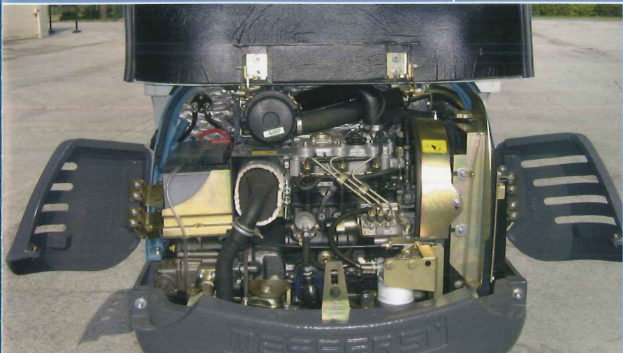
Opened lateral ballasts to improve the accessibility to the engine compartment / Offene seitliche Balläste um den Zugang zu dem Motorraum zu erleichtern / Боковые балласты открыты, что улучшает доступ к моторной нише
