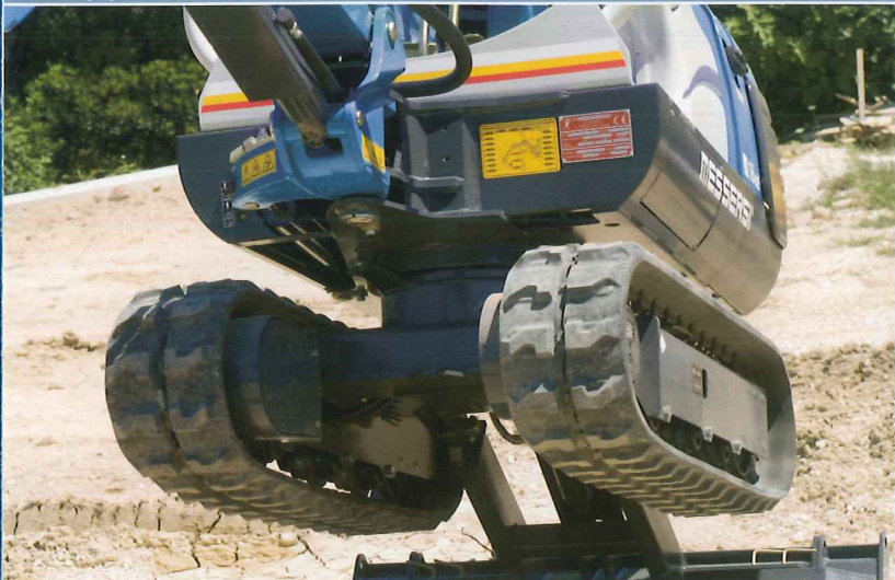
Hydraulic track widening from 1000 mm to 1300 mm (only M-18 BE), with a consequent manual adaptation of the refilling blade / Hydraulische Erweiterung der Raupenspur von 1000 mm bis 1300 mm (nur M-18BE), mit konsequenter Anpassung (manuell) an der neuen Breite vom Eingrabbungsblatt / Гидравлическое расширение колеи от 1000 мм до 1300 мм (только в M-18BE), с последующей ручной регуляцией резака закапывания на новую ширину
